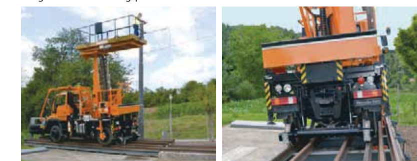
Testgleis mit Überhöhungsprüfstand / Cant test track
